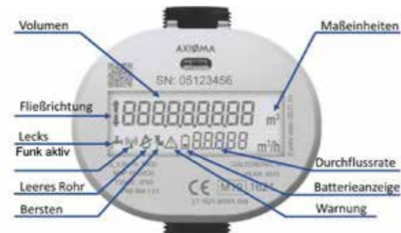
Diese Abbildung erläutert die wesentlichen Werte und Symbole, die auf dem LCD-Display des elektronischen Wasserzählers angezeigt werden können.
